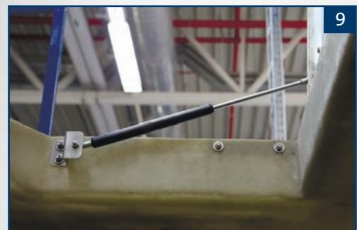
Пневмоцилиндры позволяют легко открывать крышку люка, на которой имеется специальное противоскользящее покрытие. В качестве опции предлагается теплоизоляция. Высокая рама люка защищает от случайных падений. Люк запирается.
