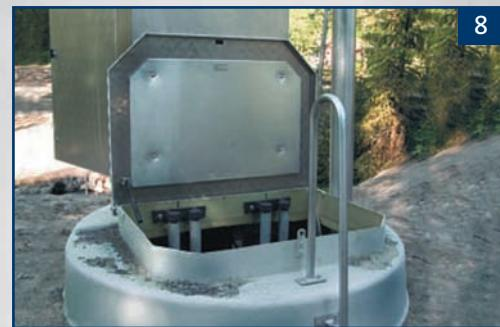
Люки с алюминиевыми крышками и теплоизоляцией. Поручни стандартно изготовлены из алюминия (нержавеющая сталь в качестве опции). Вентиляционные трубы стандартно изготовлены из нержавеющей стали (AISI 304) (пластик в качестве опции).
